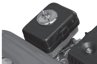
Fig. 30 – Filtro de aire
