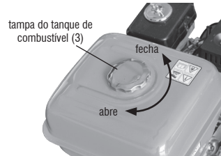
Fig. 6 – Tampa do tanque
