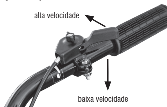
Fig. 11 – Posição da alavanca do acelerador
